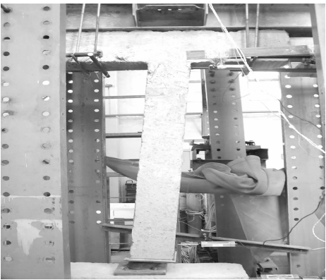
图5 串联隔震体系试件
