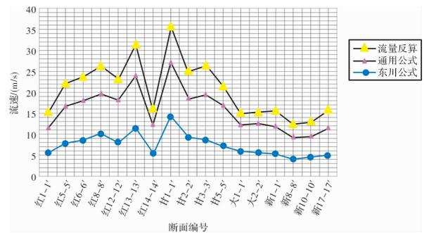
图 6 红椿沟 8.14 泥石流流速计算对比图
