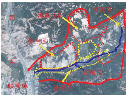
图1 汶川地震时红椿沟流域崩滑-碎屑流堆积
