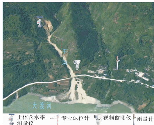
图3 干沟泥石流监测方案布置图
