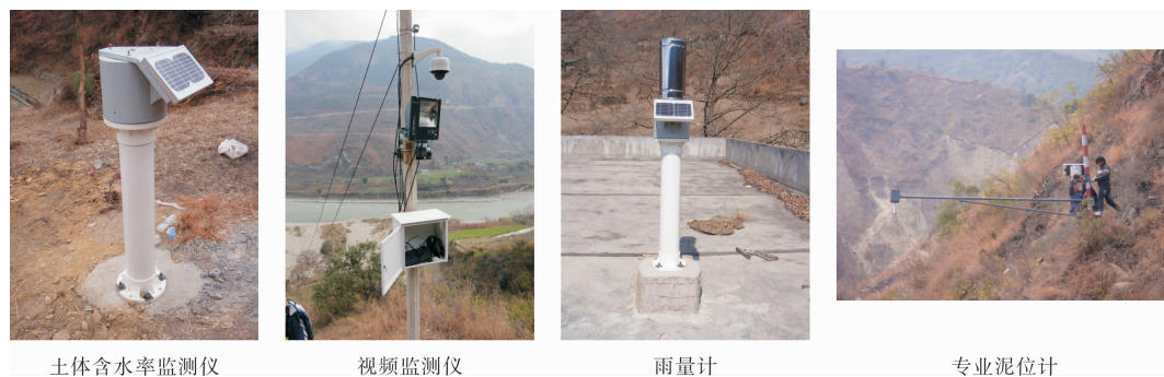
图4 监测仪器安装后照片
