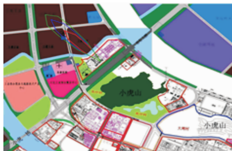
图 3 液氨整体破裂事故后果图(东南风)
