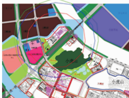
图 2 液氨整体破裂事故后果
