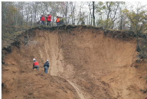
图 4 马岔沟滑坡体剪出后抛物滑面(镜像 150°)
