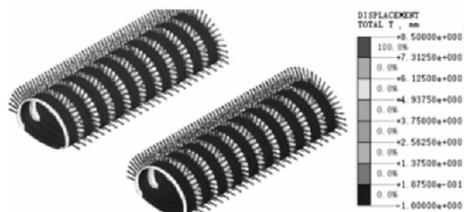
图 11 考虑应力状态下支护结构位移情况
