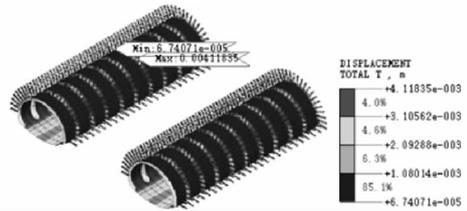
图 8 不考虑地应力下深埋隧道围岩支护结构位移情况
