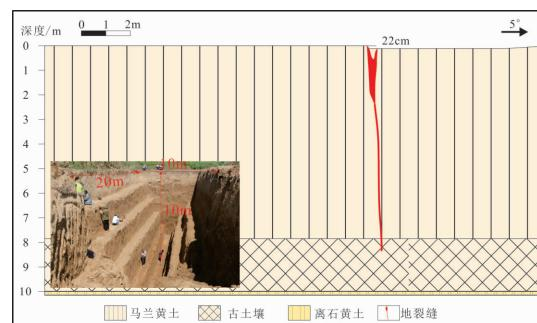
图5 西白村地裂缝剖面结构图
