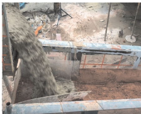
图10 泥石流翻坝入沟触底减速
