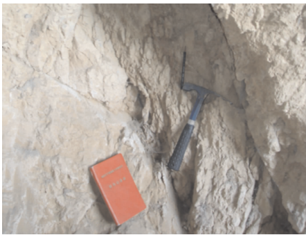
图2 后壁滑带
