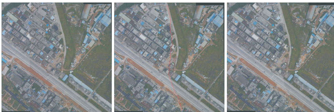
图8 动态规划法最佳拼接缝搜索拼接效果图
