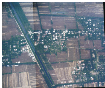
图6 曝光差异导致的拼接问题
