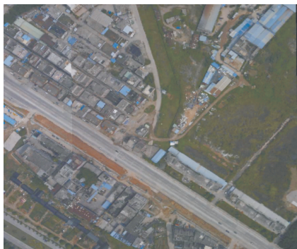
图5 存在匹配误差导致的拼接问题
