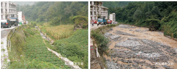
图 3 冷木沟下游泥石流发生前后沟道淤积变化对比特征 [9]
