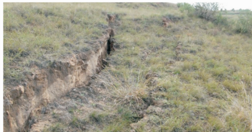
(c) 神木县大砭窑煤矿工作面上的裂缝槽
