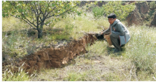
(a) 神木县鑫轮煤矿开采导致二道沟村1组黄土梁顶部出现直线形裂缝
