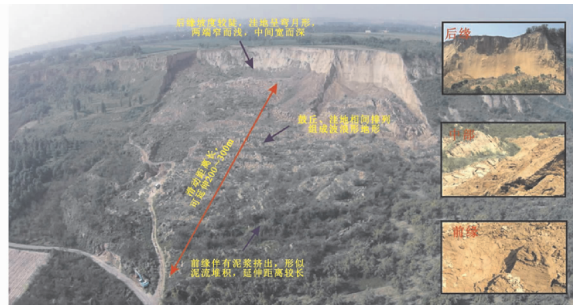
图5 泾河南塬典型典型滑坡整体发育形态——以西庙店滑坡为例
