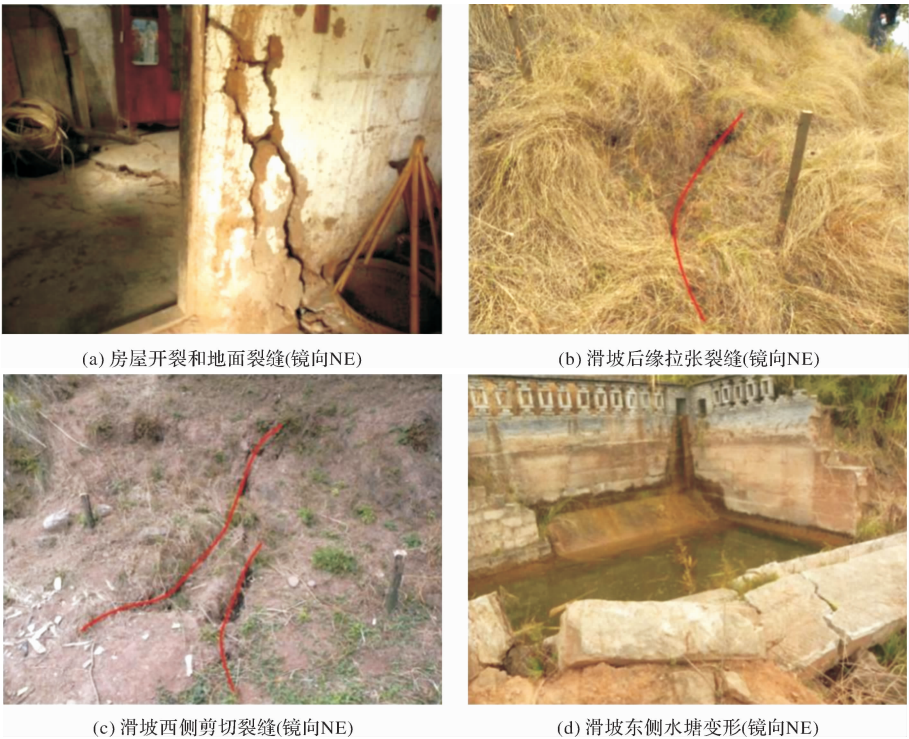
图 4 向城小学滑坡变形破坏特征
