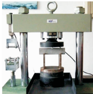
图7 中原阁楼建筑抗折实验设备
